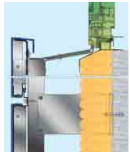
ALUCOBOND® Fensterbank mit innenliegender Entwässerung - Vertikalschnitt
